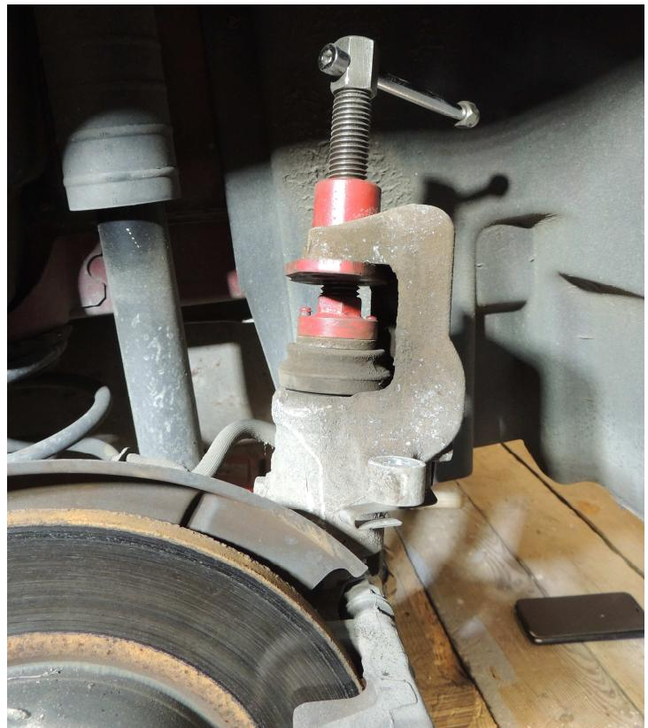
Remettre l'étrier de frein en place attention au fil du capteur d'usure et serrer les vis (1b) au couple préconisé.**2.7 à 3 daNm**
